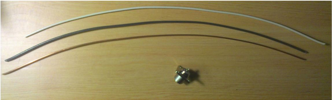
Pela la parte externa del cable. Tendrás un cable descubierto y dos cables, blanco y negro, aislados. Pela estos y tendrás tres cables de cobre descubierto.
